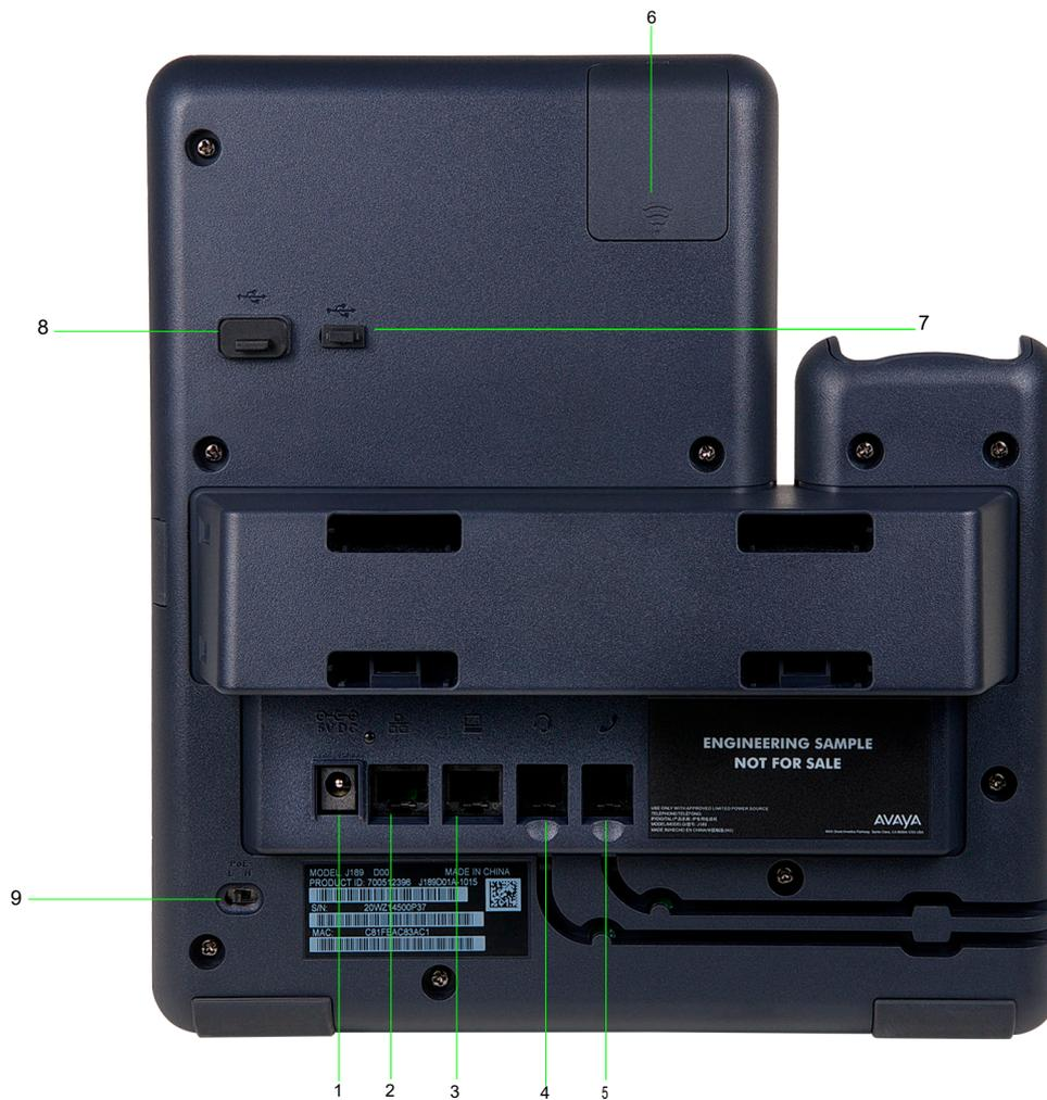
Das Schema zeigt, welches Gerät an welche Buchse angeschlossen wird.
